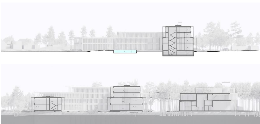
Sektion genom föreslagen ny byggnad (överst) och genom befintlig byggnad med påbyggnad, förbindelsegång och föreslagen ny byggnad (nederst), sett från väster. Bild: Krook & Tjäder
