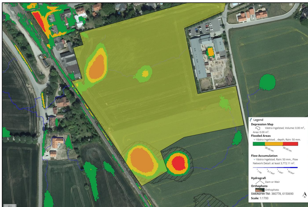
Figur 4-3. Vattenansamling i lågpunkter vid kraftiga regn. Ett fiktivt regn på 50 mm belastades i Scalgo Live modellen där ingen typ av infiltration togs i beaktande, det vill säga att färgarna i de lågpunkterna är endast representativa för volymkapacitet.
