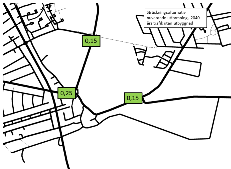
Figur 10. Belastningsgrader utan utbyggnad av förbifarten.
