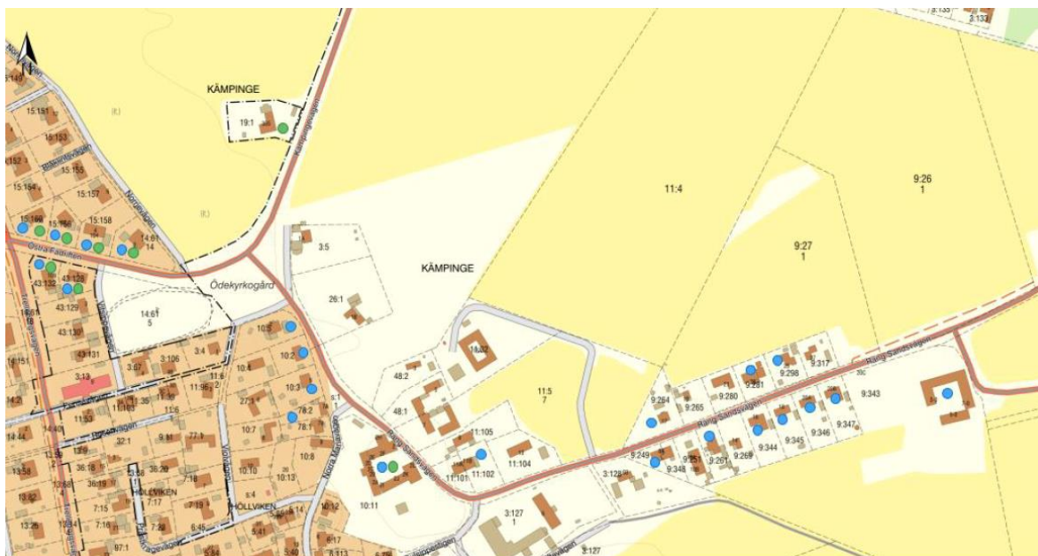
Figur 23. Utsnitt från bullerutredning (WSP, 2023-06-09). Blå prick markerar fastigheter som överskrider riktvärde för fasad vid ekvivalent ljudnivå för nollalternativet. Grön prick markerar fastigheter som överskrider riktvärde för fasad vid ekvivalent ljudnivå för alternativet med föreslagen vägutbyggnad.
