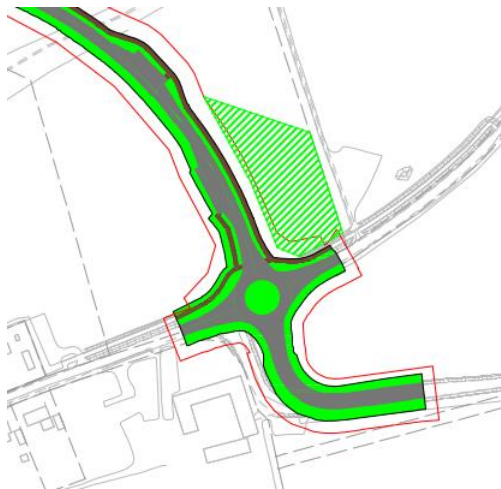
Figur 17. Schematisk yta för dagvattenhantering redovisas med grön skraffering norr om cirkulationen.
