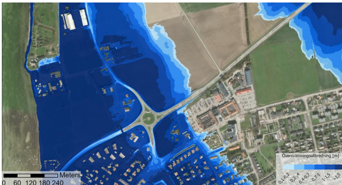
Figur 4. Översvämningsskartering och vattendjup i meter för havsnivån +4,1 m för befintlig situation.
