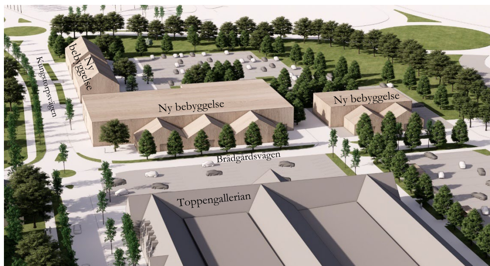
Skiss mot väster. Gavelmotiv, sadeltak och entréer mot Brädgårdsgatan bryter ner skalan och skapar en välkomnande entré. (Fojab)
