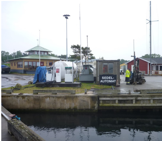
Figur 4. Provtagning av punkt 2. I denna punkt noterades inga föroreningar av oljekolväten i jord eller grundvatten. På vänster sida om cistern och pumpar noterades oljekolväten i uttagna jordprover.
