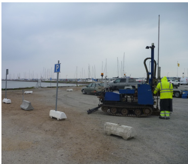
Figur 6. Provtagning av punkt 17 inom parkeringsplats, tidigare båtuppställningsplats. Den övre jorden är förorenad av PCB och PAH med hög molekylvikt.
