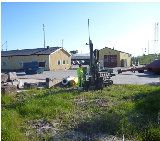
Figur 5. Provtagning av punkt 3 inom bojverkstaden. Den övre jorden utgörs av fyllning av blästersand, vilket syns tydligt i figuren. Den ytliga jorden är förorenad av koppar och tenn.
