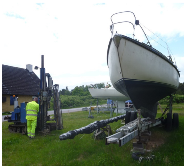
Figur 9. Provtagning av punkt 19. Föroreningar av bly noterades i den övre jordlagerprofilen.
