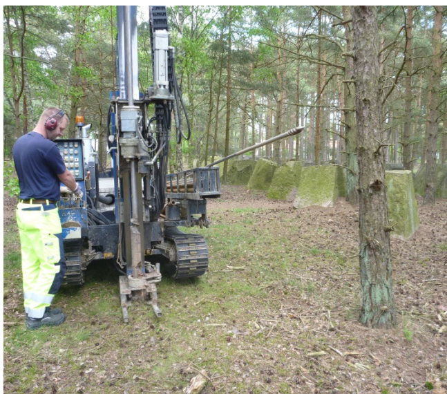
Figur 10. Provtagning av punkt 15. I denna punkt noterades en halt av lättflyktiga kolväten med bärbart PID-instrument, i en halt om 40 ppm. I prov analyserat på laboratorium påvisades inga oljekolväten.
