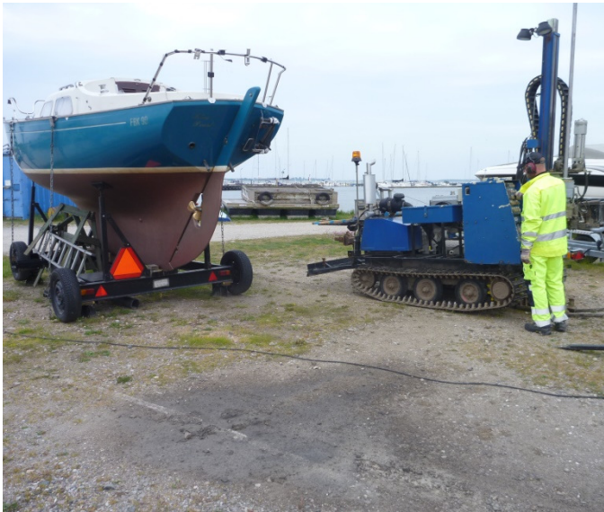
Figur 7. Provtagning av punkt 7 inom båtuppställningsplatsen. I den mörka fläcken i bildens nedre vänstra hörn uttogs prov 7B. Ytjorden inom området är förorenad av koppar och PCB. Halterna av tenn är relativt höga. I punkt 7B är jorden förorenad av metaller, oljekolväten och PAH i relativt höga halter.
