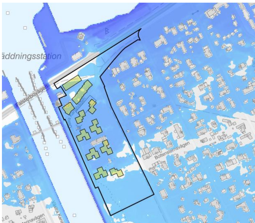
Figur 5 Visualisering av översvämningsutbredning inom planområdet vid +3,7 m (RH2000). Denna nivå motsvarar en händelse som Backafloden år 2125. Svart markering visar planområdet och gula polygoner visar planerade byggnader.
