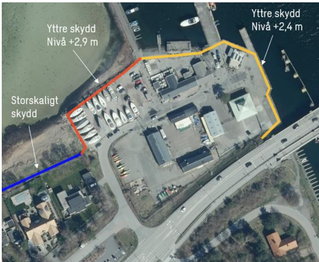
Figur 3. Föreslaget yttre skydd för översvämning mot hav tillsammans med dimensionerande nivåer år 2075.
