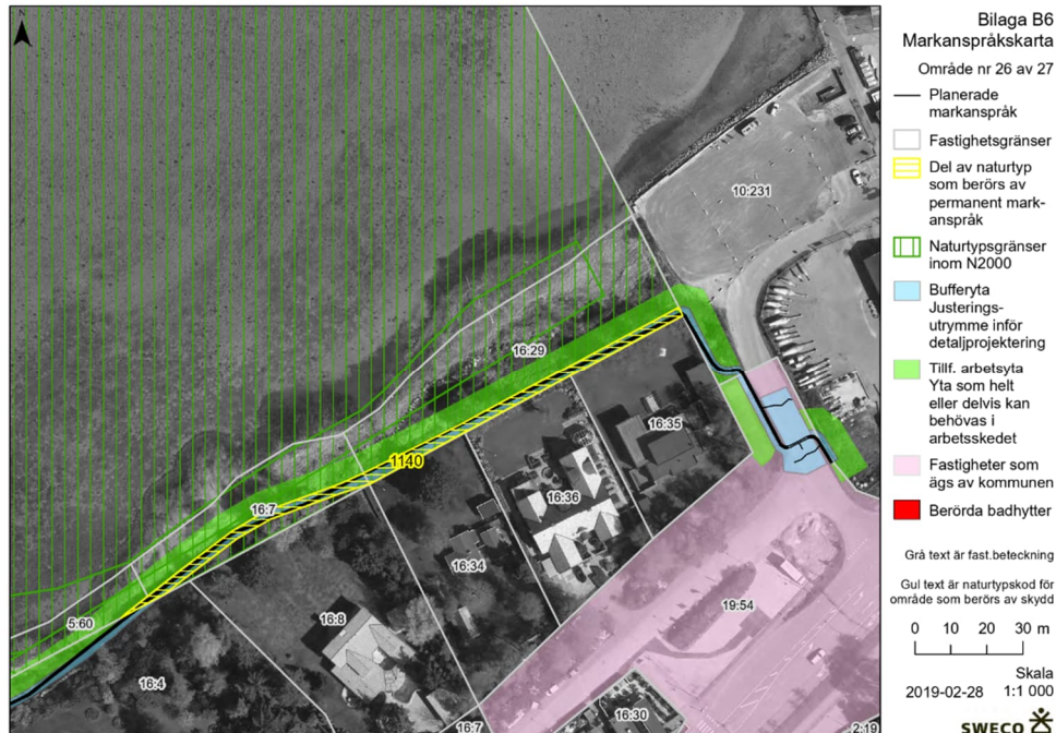
Figur 4 Högvattenskyddet vid Västra Hamnplan. med murliknande utformning utmed fastigheterna i väster fram till passagen tvärs Västra Hamnplan. Källa: Vellinge kommun.
